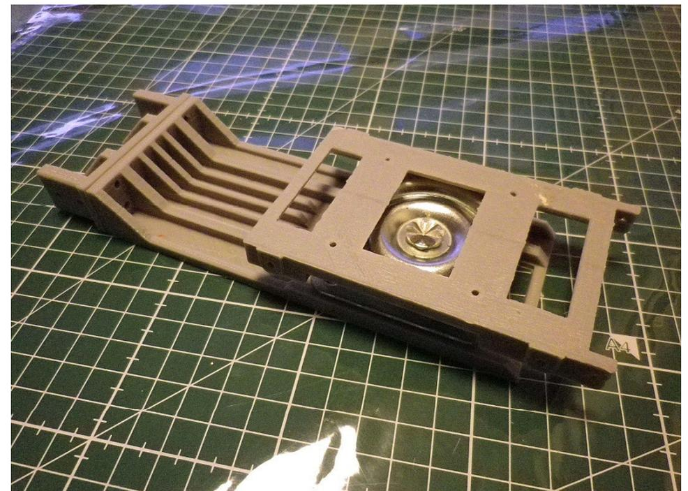
Vorderachse: waagerechte Federaufnahme /
