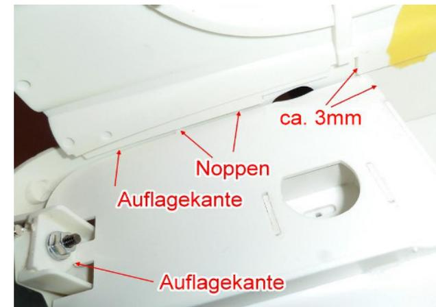
Der Kabinenboden kann nun von unten über die hintere Abstützung in das Fahrerhaus eingefädelt und vorn entlang der Karosseriebacken aufgelegt werden (leichtes Drücken reicht). Die Noppen stehen dann über der Mutter der Armaturenbretthalter auf.
