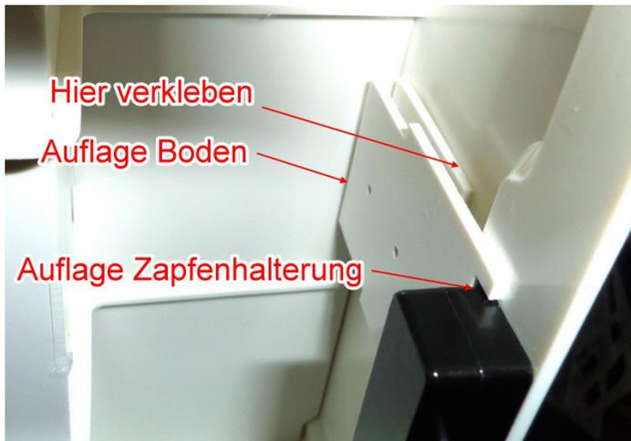
Oben sieht man die Montage der Abstützung an der Fahrerhausrückwand. Die Verklebung kann auch nur mit Doppelseitigem Klebeband geschehen.
