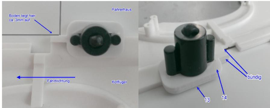
Die Unterfütterung wird wie oben gezeigt von oben an die Kotflügleinheit herangeschoben und bündig mit der Kante des Ausschnitts im Fahrerhaus verklebt. Das Kippbegrenzerlager wird später darauf fixiert.
