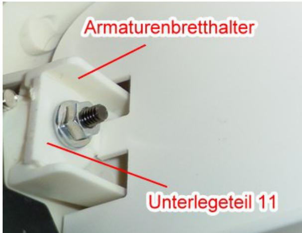
Zum Ausgleich der nun fehlenden Sitzhalter werden die Unterlegeteile (11) auf den Armaturenbretthaltern platziert, damit hat die Bundmutter wieder eine Auflagefläche.
