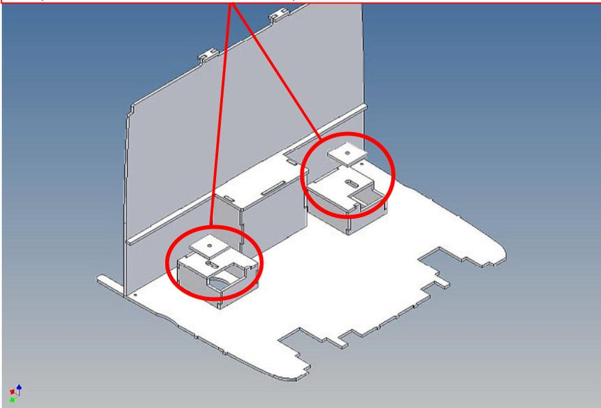
Für einen besseren Halt im Fahrerhaus die Klemmriegel, wie abgebildet, einschwenken / For a better grip in the driver's cab, swing in the clamping bars, as
