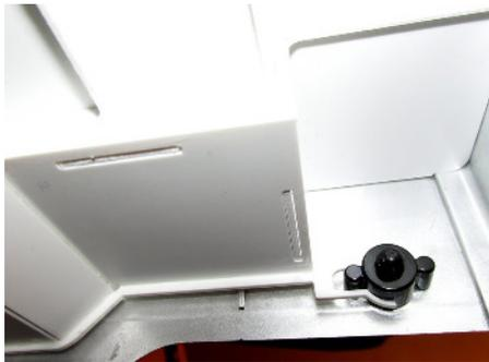
Die Abbildung oben zeigt die Anwendung der Gabel (11) sie umfasst das schwarze Lager einseitig zur richtigen Positionierung und Verklebung im Fahrerhaus. Abbildung ähnlich.
