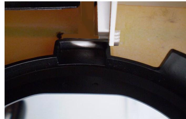
Hier sieht man deutlich wie der Kabinenboden hinten sich am Getriebegehäuse einpaßt - vorn taucht das Formstück (8) in den Zwischenraum der schwarzen Bodenplatte ein. Der Boden kann mit doppelseitigem Klebeband fixiert werden.
