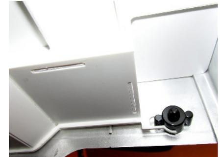
Man sieht deutlich wie der Kabinenboden von vorn über die hintere Auflage geschoben wird und wie der Kippbegrenzer platziert werden sollte. Anschließend wird der Boden vorn auf das Kippscharnier gelegt, er braucht zur leichteren Entnahme nicht weiter befestigt zu werden.
