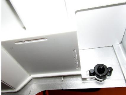
Man sieht deutlich wie der Kabinenboden von vorn über die hintere Auflage geschoben wird und wie der Kippbegrenzer platziert werden sollte. Anschließend wird der Boden vorn auf das Kippscharnier gelegt, er braucht zur leichteren Entnahme nicht weiter befestigt zu werden.
